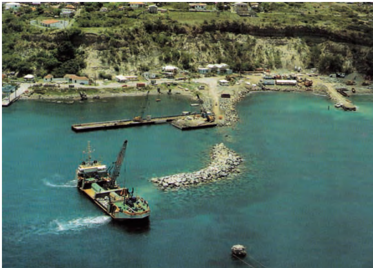
Figura 7.1.8.a C Gánguil de vertido lateral
