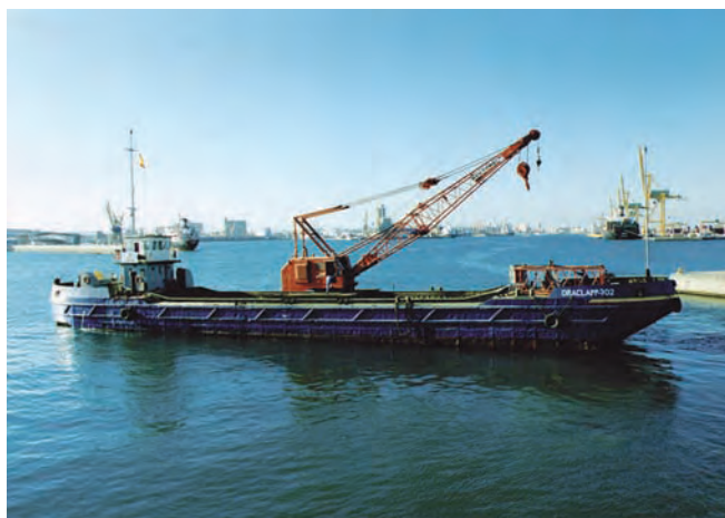
Figura 6.1.3 F Gánguil grúa
