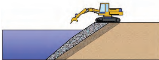
Figura 6.10.2 F Colocación con retroexcavadora segundo manto
