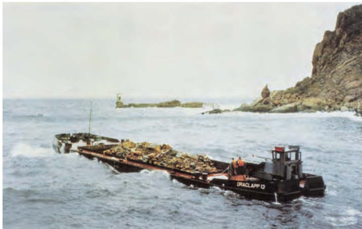
Figura 6.1.3 Q Gánguil con apertura de fondo
