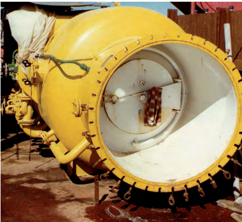
Figura 4.8 Cámara de descompresión
