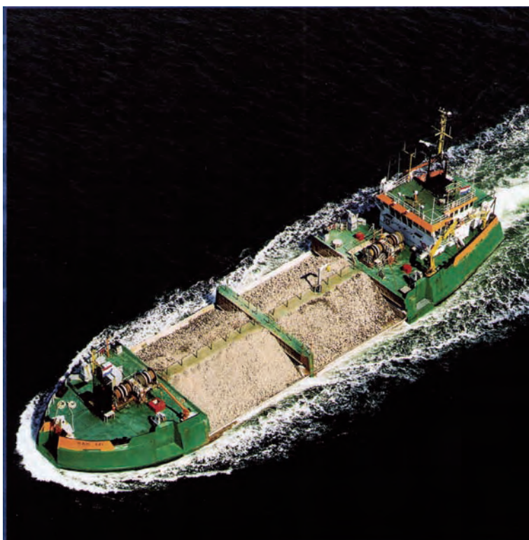
Figura 6.7.3 B Gánguil de vertido lateral
